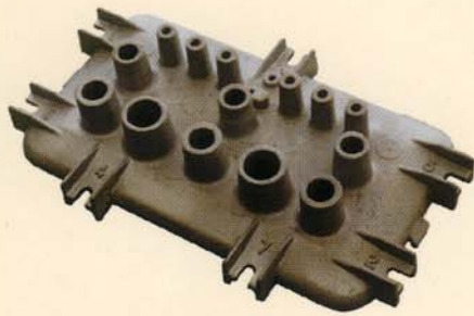
14 noyaux AS10G Y 20 - 3,200 kg. téléphonie (connexion)
