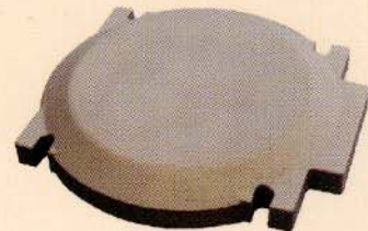
Moulage sable AS7G Y 20 - 18,500 kg. mécanique
