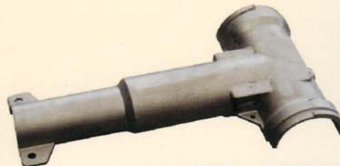
Moulage coquille AS12 Y 30 - 0,870 kg. Pièce noyautée raccord électrique
